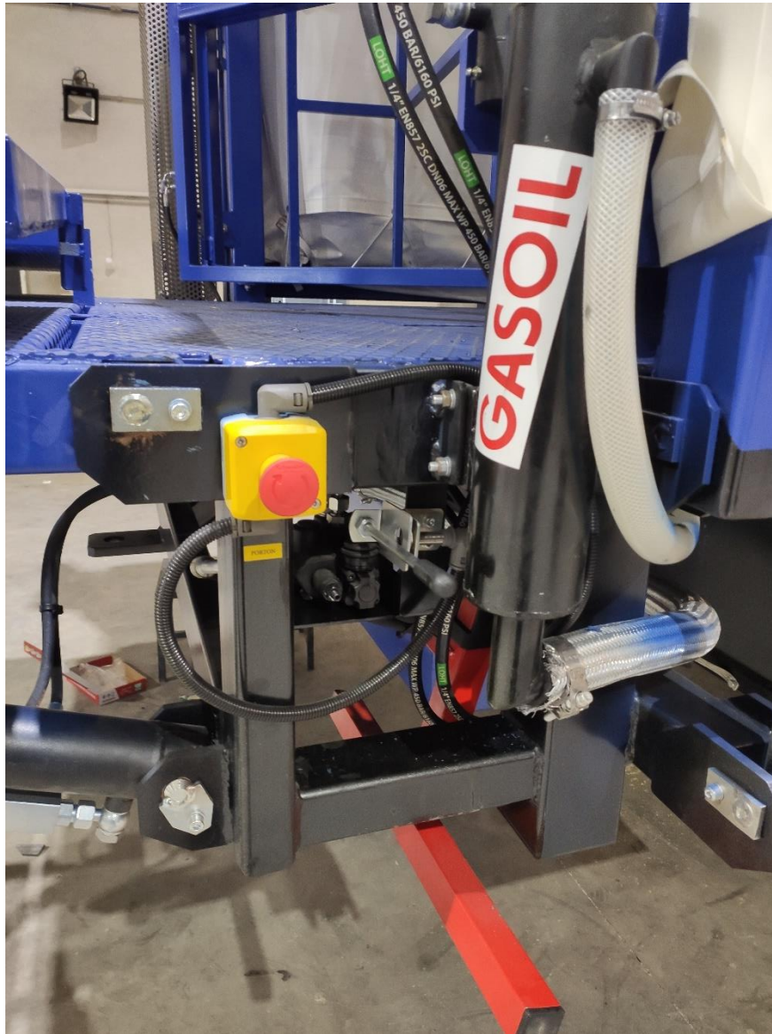
(Detalle del accionamiento hidráulico del portón de la cosechadora)
